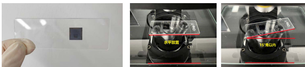
芯片放置图 (背面): 芯片号在上，二维码在下
