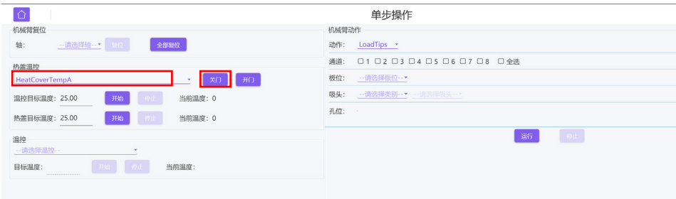
图 3-41 依次选择 A、B、C 模块的温控热盖，点击“关门”，使热盖弹出
