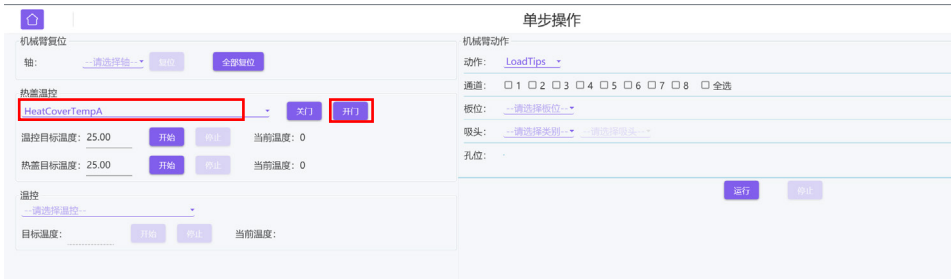
图 3-46 缩回反应热盖，保持“开门”状态（需依次操作 3 个反应模块的热盖）
