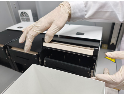
图 3-42 双手按压两侧的卡扣，打开热盖
