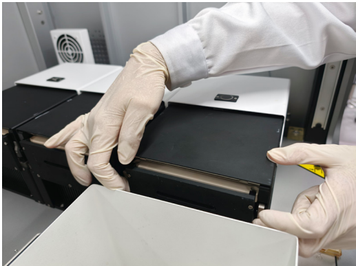
图 3-45 双手按压两侧卡扣，关闭热盖
