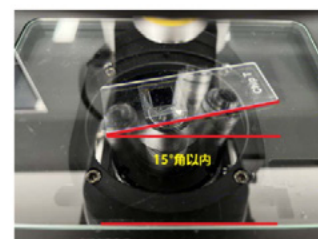
芯片放置图 (正图): 手柄在右侧
