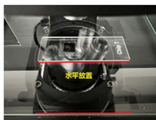
芯片放置图 (正图): 手柄在右侧
