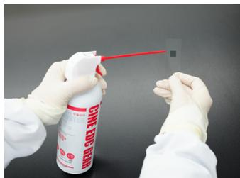
d. 当芯片表面无杂质、无明显痕迹、无任何液体残留、无波纹状纹理，即可准备贴片；
