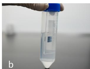
c. 清洗后用气瓶吹干芯片四周及表面，再用无尘纸吸干载玻片背面和周围多余的液体；
